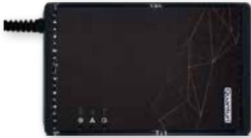
Die Tango Sensoren kommunizieren mit einer IP44 zertifizierten Basisstation, die die Temperaturmesswerte nach *quanturi.app* weiter leitet.
